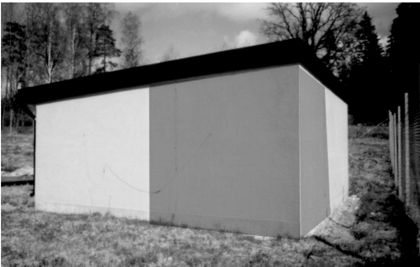
Bild 3. De impregnerade delarna av provhuset är på bilden markerade med mörkare färg. I verkligheten syns ingen skillnad på ytorna.
